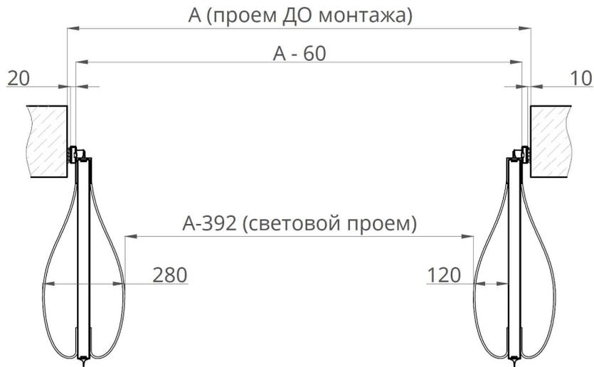
Рисунок 11. Разрез 1-1. МДД с изогнутым отбойником
